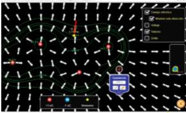
Imagen No 4: Simulación para representar las líneas de campo Eléctrico y superficies equipotenciales para cuatro cargas positivas
